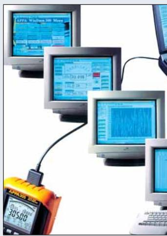
Приборы этой серии оснащены RS-232 интерфейсом с оптической развязкой, обеспечивающим безопасное и лёгкое подключение к ПК. В комплект поставки прибора APPA 305 входит оптоэлектронный кабель, адаптер и программное обеспечение APPA WinDMM 300. Всё это можно приобрести дополнительно и для остальных приборов этой серии
