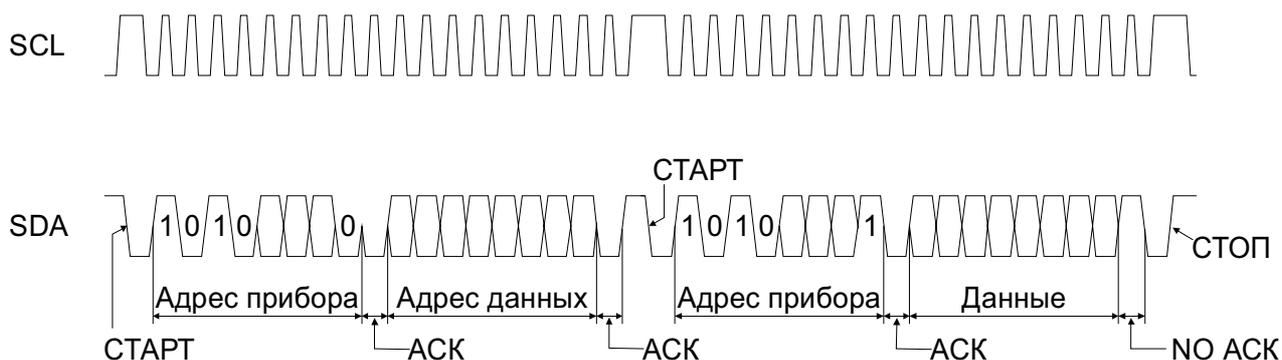
Для выполнения чтения по заданному адресу микроконтроллер должен предварительно записать в ИС адрес требуемых данных.
