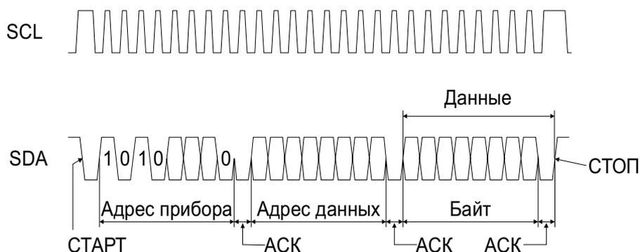
выдает сигнал **ACK** и, получив команду **СТОП** от микроконтроллера, приступает к перезаписи данных из буфера регистра данных по полученному адресу. В течение цикла перезаписи  $t_{RW}=1,5$  мс ИС не будет отвечать на обращения, а по его завершению перейдет в состояние покоя.
