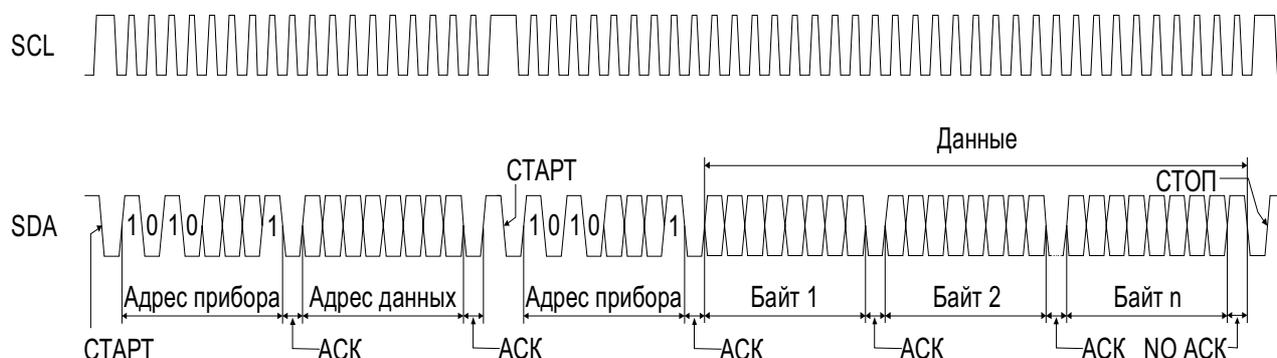
Для выполнения чтения по заданному адресу микроконтроллер должен предварительно записать в ИС начальный адрес блока требуемых данных.
