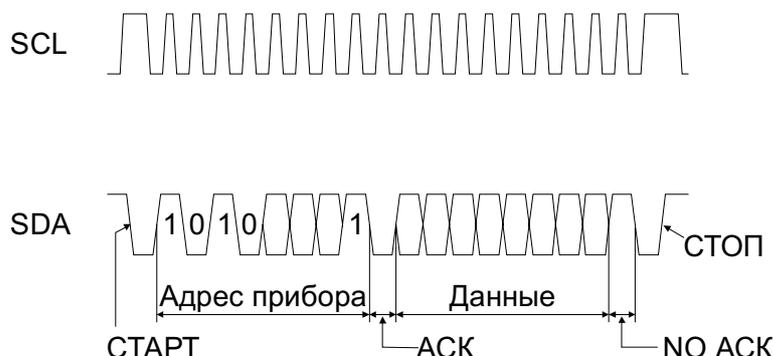
Для выполнения чтения по текущему адресу микроконтроллер выдает на линию **SDA** команду **СТАРТ** и адрес прибора (с высоким уровнем в младшем разряде), следующие непосредственно друг за другом. ИС выдает сигнал подтверждения приема адреса прибора **ACK** и байт данных, находящийся по текущему адресу выбранной ИС. Микроконтроллер, не выдавая сигнала подтверждения **ACK**, выдает на линию **SDA** команду **СТОП**.
